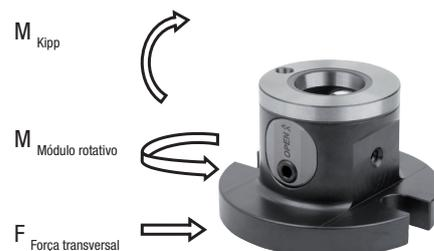
\* O funcionamento correto dos módulos de fixação, especialmente a repetibilidade, é garantida até uma força transversal de 1.000 N. A falha e a segurança pessoal dos módulos de fixação são garantidas até uma força transversal crítica de 7.000 N.
