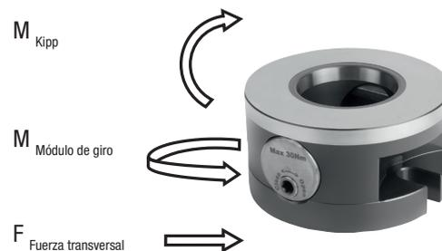
\* O funcionamento correto dos módulos de fixação, especialmente a repetibilidade, é garantida até uma força transversal de 3.000 N. A falha e a segurança pessoal dos módulos de fixação são garantidas até uma força transversal crítica de 20.000 N.
