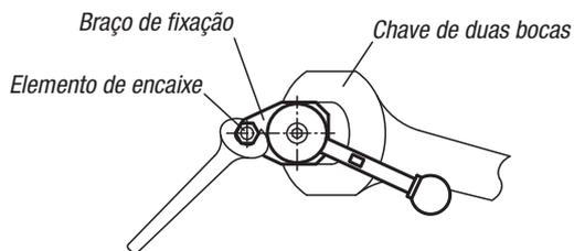
Ao encaixar uma peça no braço de fixação, trave-o utilizando uma chave de duas bocas, para que ele não sofra forças de torção.
