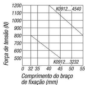
Comprimento do braço de fixação C
